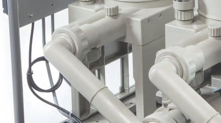
Les coalesceurs SIEBEC permettent de récupérer une huile surnageante dans un liquide. Le système est idéal pour des quantités de 1 à 25 litres d'huile par jour. La technologie **pression** possède un faible encombrement permettant une installation facilitée. La technologie **gravitaire** permet un meilleur déphasage sur les applications sensibles.
